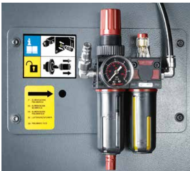
Servicebox: Manuelle Entriegelung und Druckluftanschluss an der Wartungseinheit (nur beim pneumatischen Flansch)
