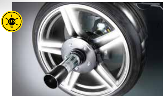
LED: Innenbeleuchtung der Felge
