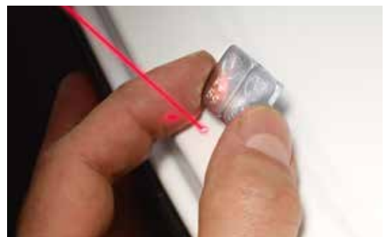
Punkt laser* zur präzisen Positionierung der Kleb- gewichte an Alufelgen (innen und hinter den Speichen)
