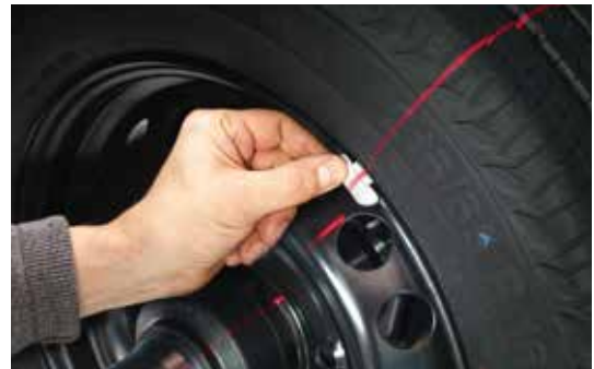
Linienlaser* zur exakten Positionierung der Schlaggewichte an Stahlfelgen außen
