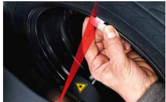
Linienlaser* für Schlaggewichte an Stahlfelgen innen
