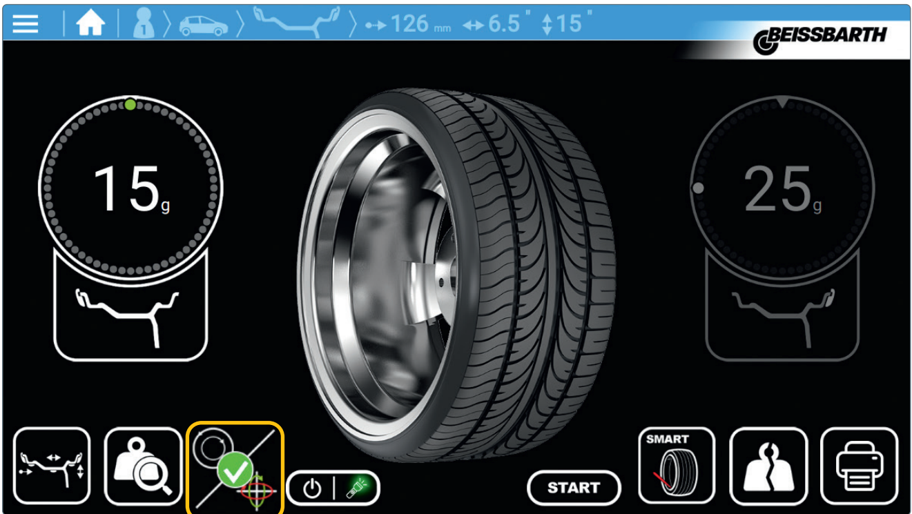
Jedes Rad wird auf Abweichung vom Mittelpunkt geprüft (Exzentrizität)
