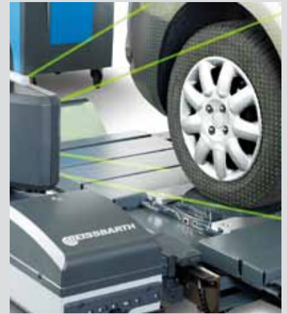
Touchless: Berührungslose Fahrwerkvermessung
