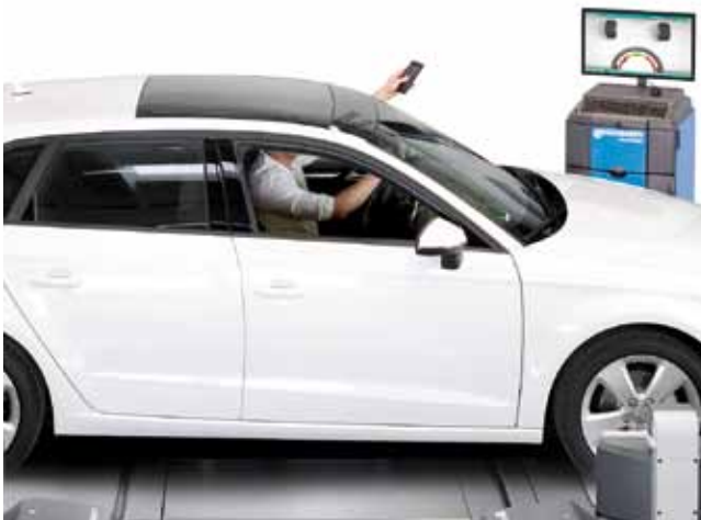
Touchless: Fahrwerkanalyse vom Fahrersitz aus
