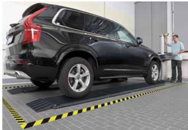
Nivellierbare Fahrzeugprüffläche LTB 100 gemäß § 29 StVZO HU-Scheinwerfer-Prüfrichtlinie
