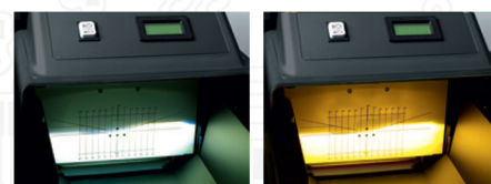
Filtru de culoare LED1 determinarea exacta a liniei cut-off pentru farurile cu LED, BI-LED
