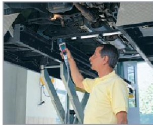
Comandi azionamento piastre su torcia con cavo di 5500mm. Standard play detector controls on torch with 5500mm cable.
