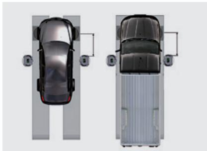
Unica posizione d'installazione delle teste per la misurazione di veicoli con passo differente.
